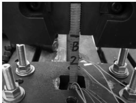
图 2 T 形焊件拉伸试验装置图
