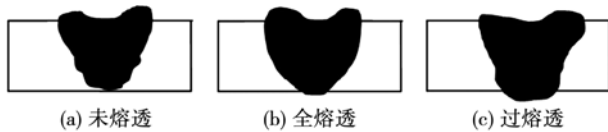
图 3 焊缝熔透状态剖面示意图
