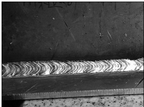
图 8 铝镁合金的半自动脉冲焊焊缝
