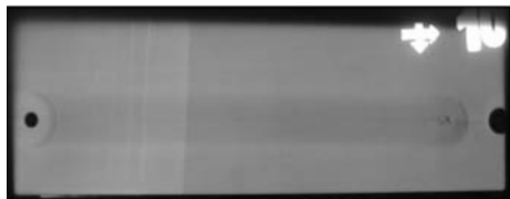
(b) 根部未焊合X射线检测
