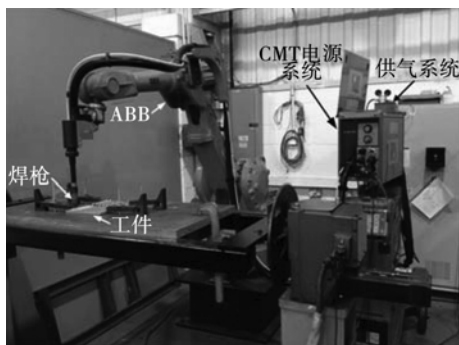
图1 CMT焊接系统 Fig. 1 CMT welding system
