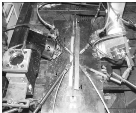
图 1 T 形接头双激光束双侧同步焊接系统
