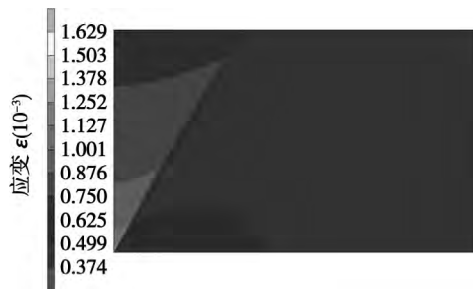
图 3 焊缝与母材杨氏模量比为 0.5 且 \alpha 为 30^\circ 时接头应变云图
