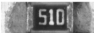
图 8 焊料不足元件及焊点图像
