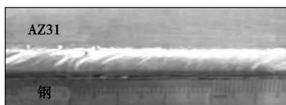
图 2 镁/钢接头焊缝成形
