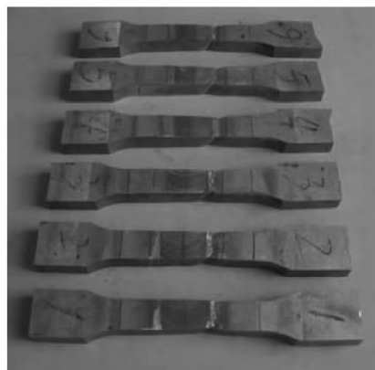
图 2 拉伸试样断裂形貌
