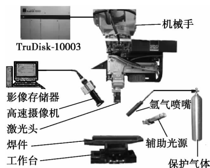
图1 激光焊接试验装置结构
