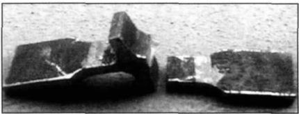
图 6 十字接头断裂位置 Fig. 6 Fracture position of cross joint
