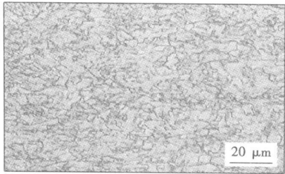
图 1 X60 钢显微组织形貌 Fig. 1 Microscopic structure of X60 steel
