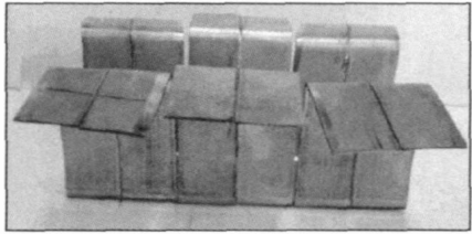
图 6 拼焊板厚/薄侧压边力为 20/10 kN、18/12 kN、14/16 kN 时试验照片(总压边力 30 kN) Fig. 6 Deformed specimens for various distributions of BHF (20/10 kN 18/12 kN 14/16 kN) (Total BHF 30 kN)
