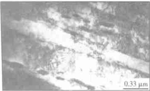
图 3 回火态(OK3 组织: 710 °C×5 h)组织中碳化物的分布 Fig. 3 Distribution of carbides in tempered weld
