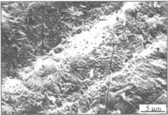
图 6 负偏压为 150 V Al 膜表面形貌
