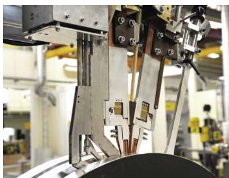
图 15 伊萨公司双丝窄间隙埋弧焊机头
