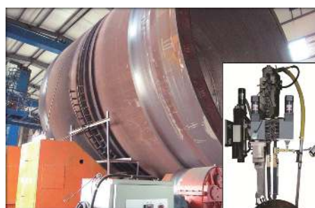
图 16 加氢反应器主焊缝双丝窄间隙埋弧焊及机头
