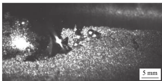
图 14 钎涂中金刚石对激光的折射和反射现象
