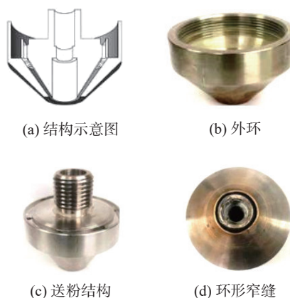
图 1 环状同轴送粉结构
