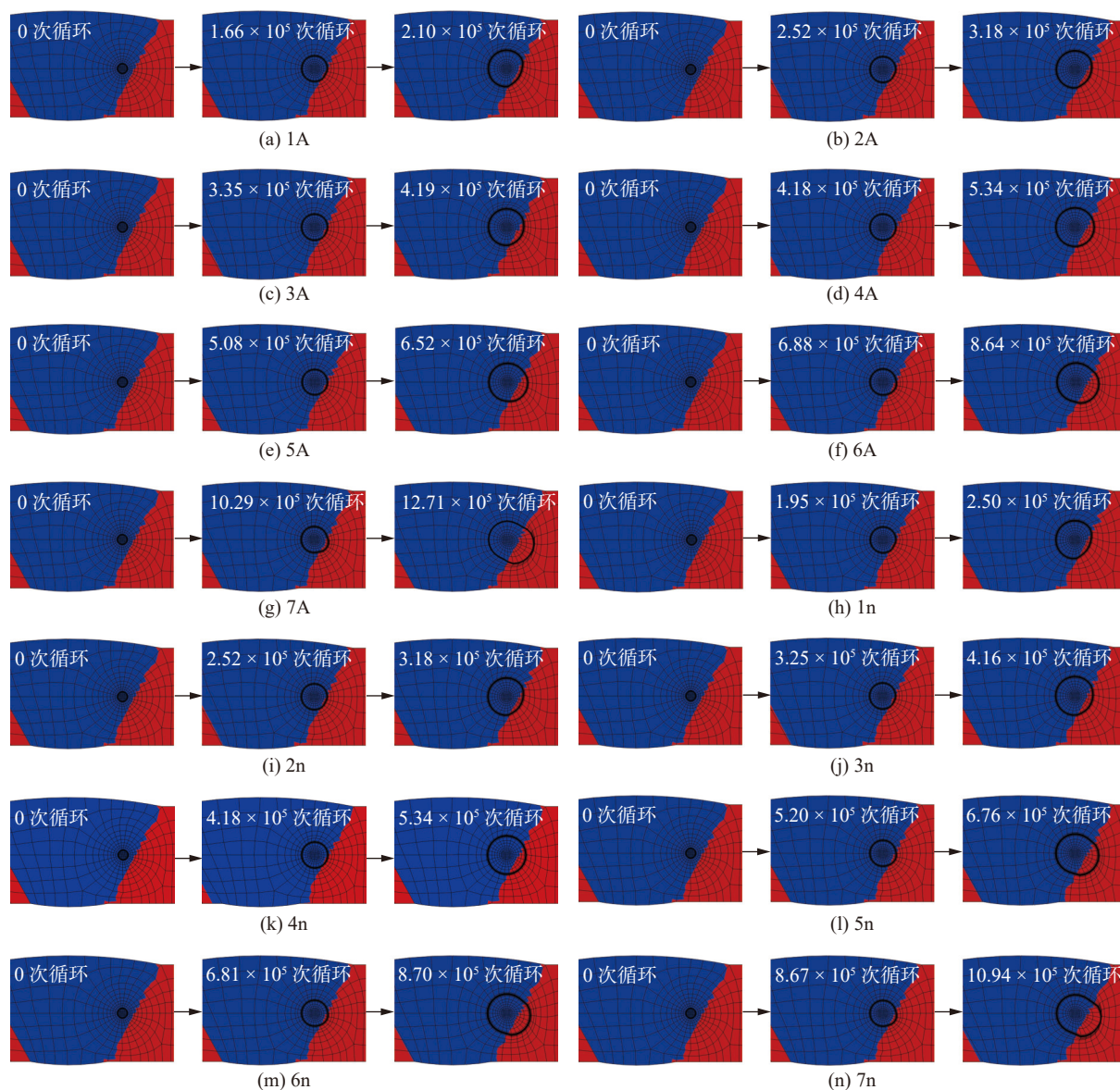
图 8 焊缝材料参数对结构裂纹拓展性能的影响
