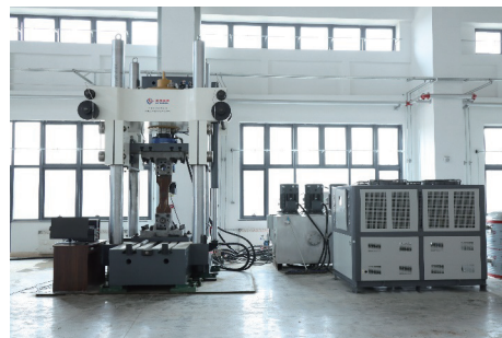
图 2 全板厚焊接节点疲劳测试装置
