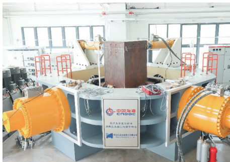
图 1 结构级疲劳测试装置
