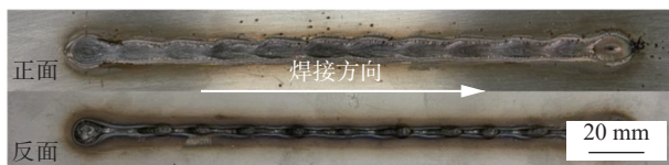
图 4 不锈钢激光-MIG 复合焊的焊缝正面及背面形貌
