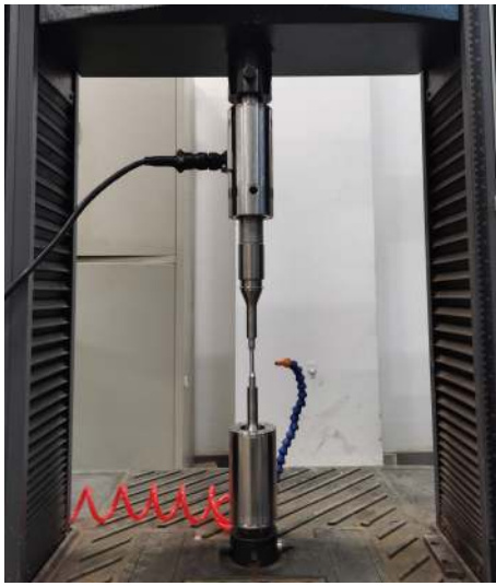
图 9 应力比 R = 0.1 的超声疲劳试验
