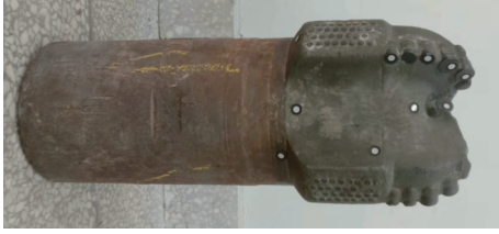
图 1 PDC 钻头贴定位标点 Fig. 1 PDC bit position punctuation
