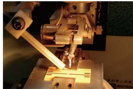
(a) 超声金丝球焊机焊接键合线
