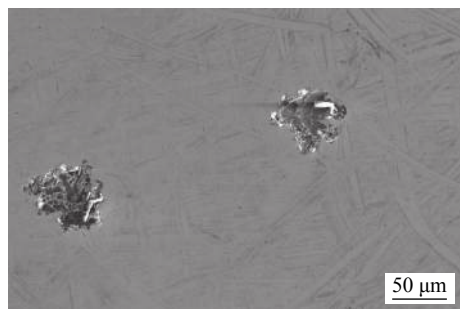
(b) 焊缝金属电化学腐蚀后表面形貌
