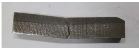
图 6 三点弯曲测试后材料试样
