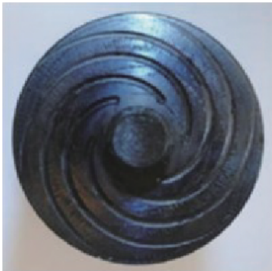
图 2 阿基米德螺型花纹轴肩 Fig. 2 Archimedes screw pattern shoulder
