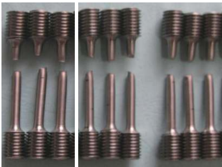
图 6 不同热处理制度下接头拉伸宏观形貌 Fig. 6 Tensile samples of TC21+TC4-DT IFW joint
