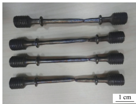
图 8 蠕变断裂试样
