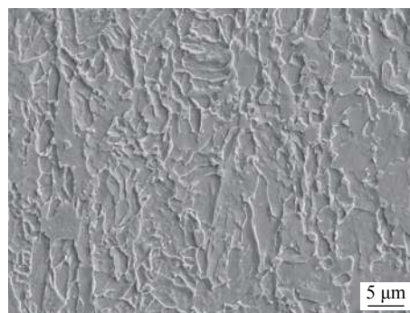
图 1 X100 管线钢母材显微组织 Fig. 1 X100 steel microstructure
