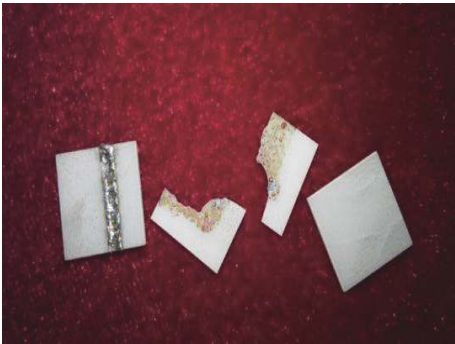
图 2 热输入过大导致陶瓷基板炸裂
