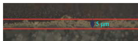
图 10 优化后激光熔覆熔覆层的微观形貌
