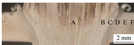
图 2 FSW 焊缝 FPW 接头宏观形貌
