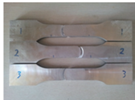
图 6 FPW 接头拉伸断裂位置
