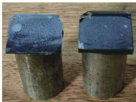
(a) 硅-玻璃-硅拉伸试样断口宏观形貌
