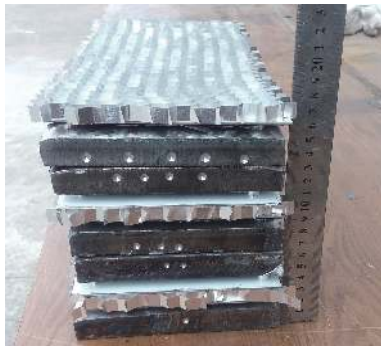
图 4 五层爆炸焊接装药实物图
