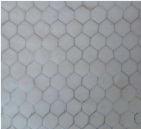
图 2 蜂窝结构炸药 Fig. 2 Honeycomb structure explosive
