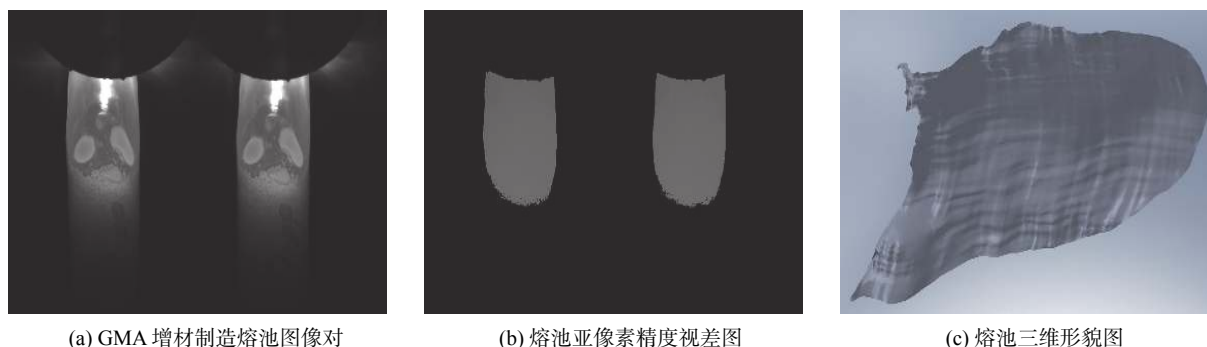
图 4 GMA 增材制造熔池形貌三维重建
