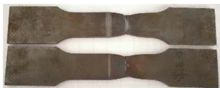
图 9 拉伸试样断裂示意图 Fig. 9 Tensile sample fracture morphology
