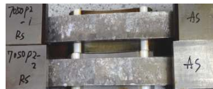
(b) 时效处理后 SCC 试样 (60 天未断裂)
