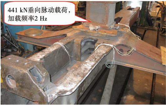
图 8 牵枕结构疲劳试验 Fig. 8 Fatigue test of pillow structure
