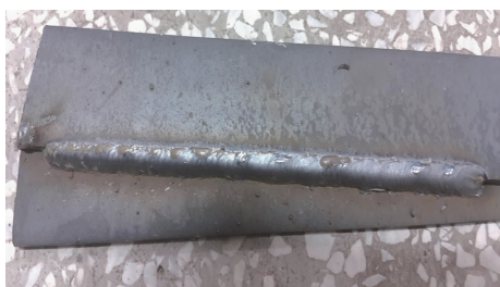
图 9 焊缝跟踪效果图
