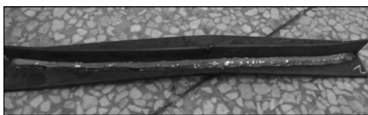
图 7 高度方向变化弯曲角焊缝跟踪结果
