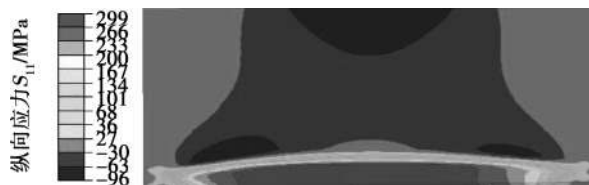
图5 7A52 铝合金试板纵向残余应力分布云图
