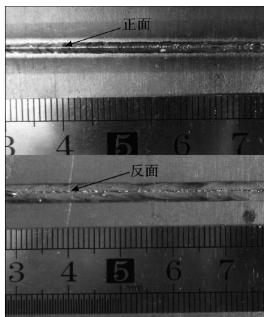
图 1 I 组焊缝形貌
