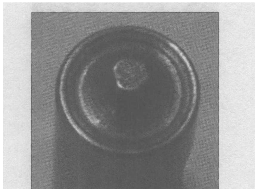
图 2 搅拌头原始形貌 Fig 2 Original profile of pin tool
