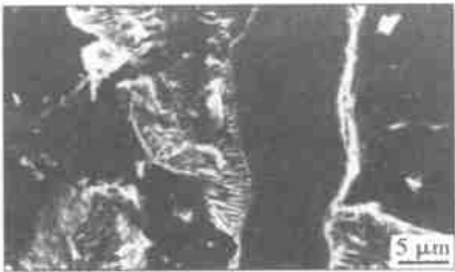
(b) 接头残留中间层与母材界面的扫描电镜照片
