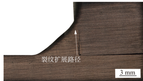
图 8 搭接接头-C 疲劳断裂试样示意图 Fig. 8 Schematic diagram of lapped joint-C fatigue fracture
