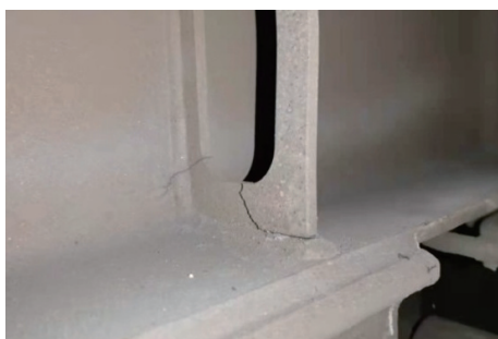
图 1 横向减振器座的焊缝开裂
