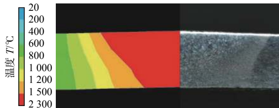
图 4 焊缝区形貌比较
