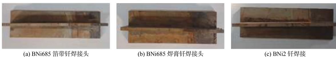
图 11 三种钎料钎焊接头腐蚀后微观形貌
