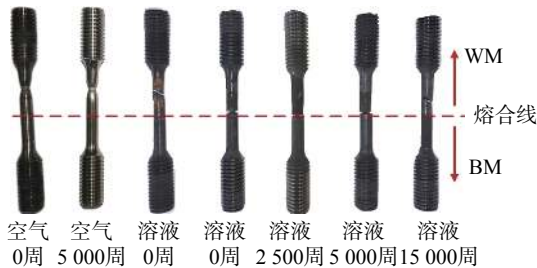
图 5 SSRT 试样的断裂位置 Fig. 5 Fracture location of SSRT specimens
